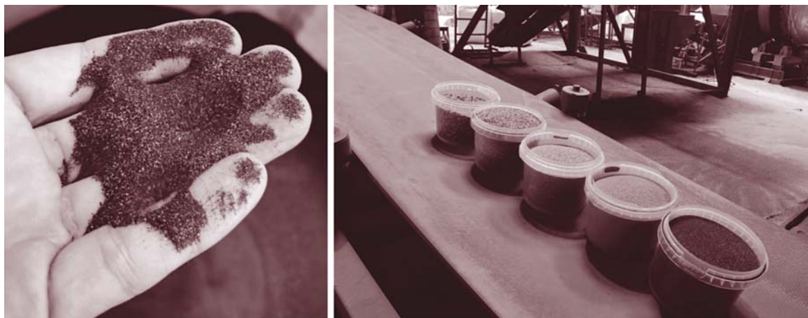
Ильменитовый концентрат (сырье для изготовления титана), полученный в цехе в рп. Латная
